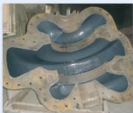
A szivattyúház felújítás után.
